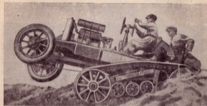
Рис. 433. Полуусеничный тягач Альфа-Ромеа с двойным штурвалом управления для заднего хода.
