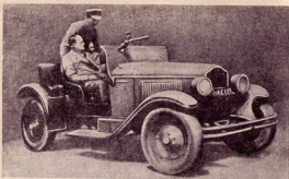
Рис. 549. Полубронированная командирская машина Т. 1 (У). Шасси Уиллис и Понтиак. Двигатель: вес 1,3 т, мощность мотора 50 л. с., максимальная скорость 80 км/час.
