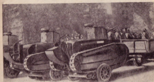
Рис. 431. Одноосная четырехколесная прицепка для перевозки танков на буксире.
