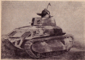
Рис. 461. Средний танк М. 94, вид сзади. В задней стенке башни виден второй пулемет. Новым во внешнем виде танка является наличие хвоста, а также сплошной части бронирования двигателя.
