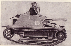
Рис. 705. Переделанная танкетка Карден-Лойд марки VI, применяемая для полицейских целей в Японии.
