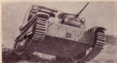
Рис. 426. Малый танк Фиат-Ансальдо М. 1933, вид спереди. Видна характерная установка для пулемета с воздушным охлаждением в виде сферической маски с возможностью придания пулемету угла поворота и наклона.
