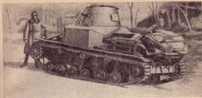
Рис. 451. Легкий танк М. 2593 (1933 г.), вид сбоку. Отчетливо видна сварная конструкция броневго корпуса.
