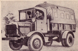
Рис. 562. Войсковая стандартная машина Ф. В. Д. (Фор Уил Драйв). Ее стандартные агрегаты применяются также для среднего кавалерийского броневомобиля Т. 11.
