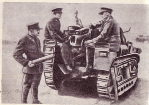
Рис. 645. 75-мм полевая пушка на самоходной установке в огневом положении.
