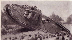
Рис. 634. Тяжелый танк марки VIII, вид сбоку в момент преодоления земляной насыпи.
