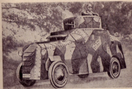
Рис. 497. Легкий броневомобиль Тидархольм М. 26, второй вариант со скошенными углами бронирования.
