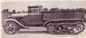
Рис. 759. 8-цилиндровый 1,5-т грузовик Форд с полугусеничным двигателем фирмы Кэннингем (США).
