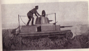
Рис. 700. Японский легкий танк обр. «93» с радиоустановкой.
