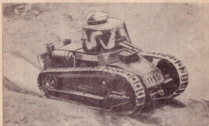
Рис. 416. Легкий танк Фиат 3000 А со спаренной пулеметной установкой в башне.
